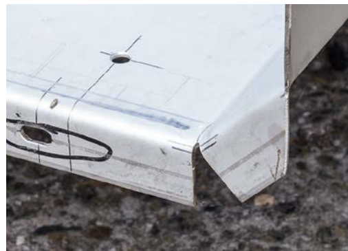
Die Fase am Übergang vom waagrechten zum senkrechten Teil der Platte hilft, wenn der Trog im Stall nicht 100%ig gerade ist. Auch setzen sich hier keine Futterreste mehr fest. Das serienmäßige Langloch bewirkt eine einheitliche Höhe der Platten...
