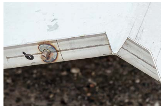
...indem auf der anderen Seite der Platte werkseitig eine Niete gesetzt ist. Nach dem Einschieben der Niete ins Langloch entsteht zwischen zwei Platten eine Verbindung mit einheitlicher Außenhöhe.
